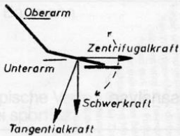
Abb. 1 Teilkräfte an einem schwingenden Unterarm
